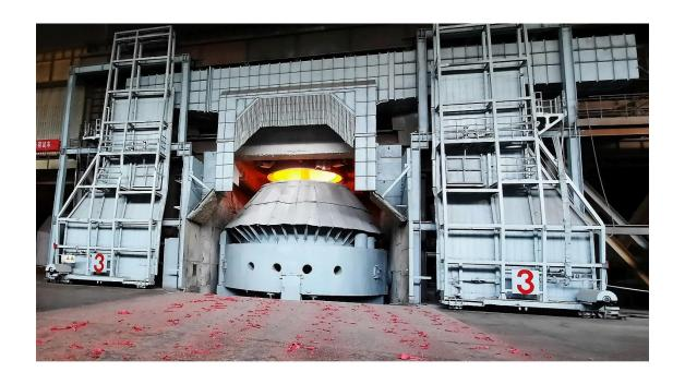
プライメタルズテクノロジーズが BOD 転炉から更新した KOBM 転炉が中国河北省邯 鄲にある HBIS 製鉄所で稼働開始
