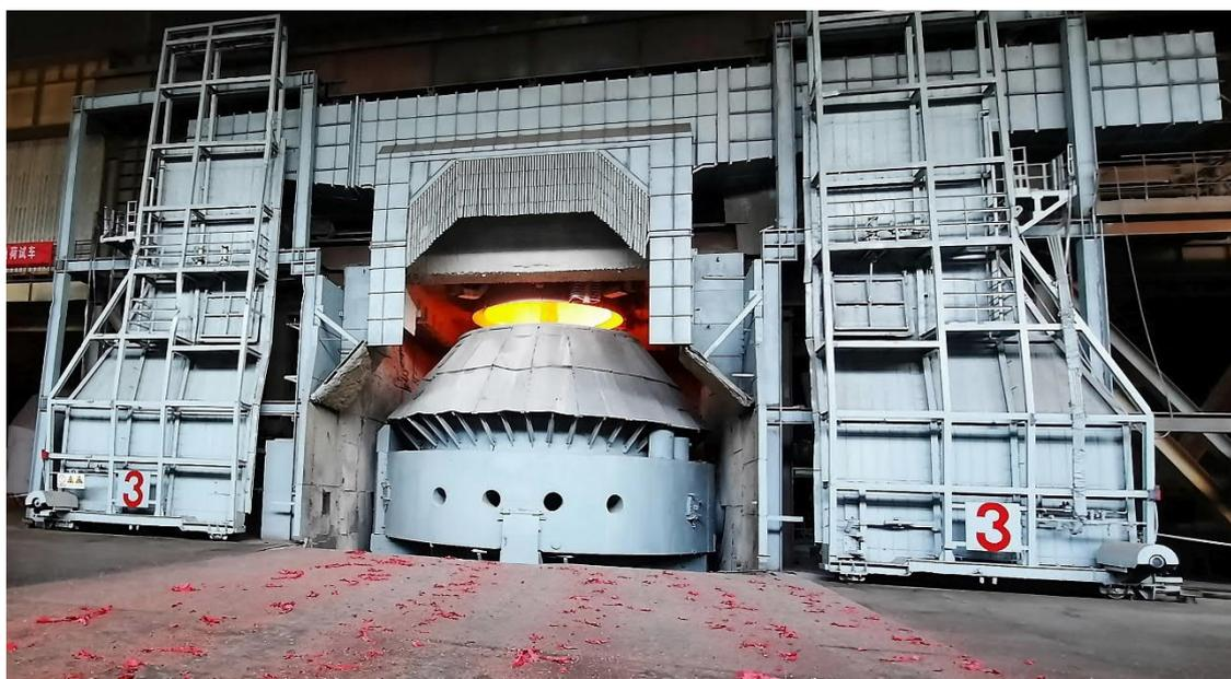
КОВМ-конвертер (результат модернизации BOF-конвертера), запущенный Primetals Technologies на сталелитейном заводе HBIS Group Handan Iron and Steel в г. Ханьдань, Китай в начале ноября.
