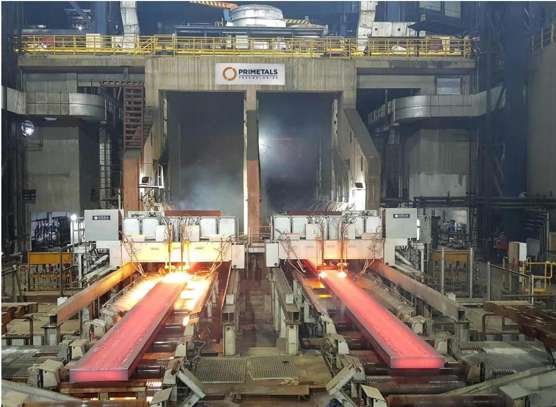
印度 JSW 钢铁公司 Dolvi 厂安装的普锐特冶金技术板坯连铸机。
