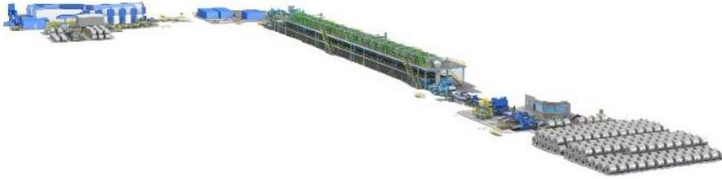
奥钢联钢铁公司奥地利林茨第三冷轧厂的酸洗冷轧联合机组(左侧为冷轧机，中间是带钢运行段，右侧是入口)。普锐特冶金技术将提供核心部件、工艺设备和生产线集成。
