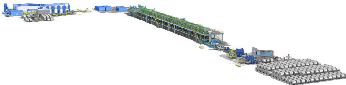
Beiztandem-Verbindung (Tandem – links, Bandlaufbereich – Mitte, Einlauf – rechts im Kaltwalzwerk Nr. 3 der voestalpine Stahl GmbH in Linz, Österreich. Primetals Technologies liefert Kernkomponenten und -Aggregate, sowie Prozessmaschinen und deren Integration in die Gesamtanlage.
