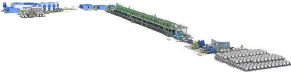
Linha de decapagem contínua (tandem à esquerda, área de passagem de tira no centro e entrada à direita) da laminação a frio nº 3 na usina da voestalpine em Linz, Áustria. A Primetals Technologies fornecerá os principais componentes, máquinas de processo e a integração com a planta existente.
