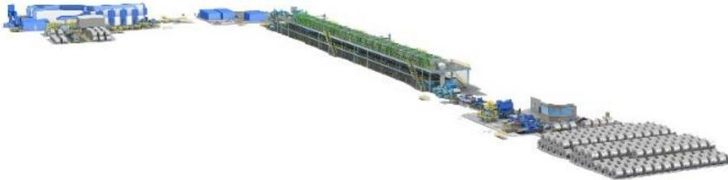
Тандемная линия травления (тандем слева, участок транспортировки полосы в центре, вход справа) на стане холодной прокатки №3 на предприятии voestalpine в г. Линц, Австрия. Primetals Technologies поставляет основные компоненты, технологическое оборудование, а также выполняет их интеграцию в текущий комплекс.
