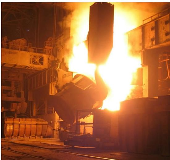
До модернизации: В сталелитейном цехе были масштабные выбросы отходящих газов в ходе заливки жидкого чугуна в конвертер.
