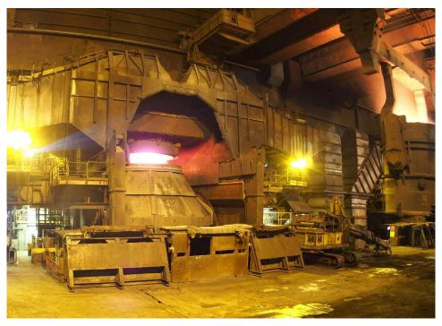
Загрузка нового LD-конвертера на сталеплавильном заводе ArcelorMittal в г. Гент во время первой плавки
