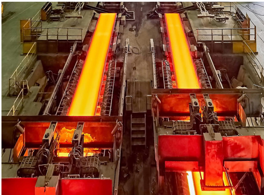
创下世界纪录的 Çolakoğlu 土耳其 Dilovası 厂的双流板坯连铸机。
