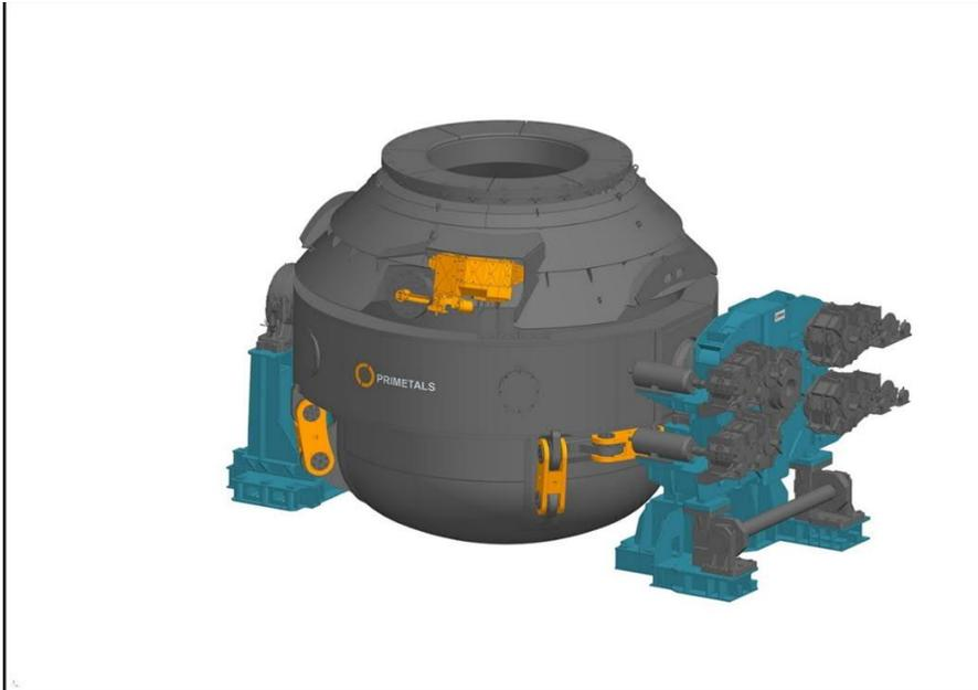
Primetals Technologies wird ArcelorMittal mit zwei neuen LD-Konvertern (BOF) beliefern, hier mit dem Kippantrieb abgebildet.
