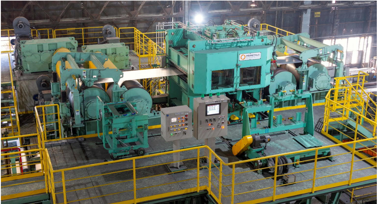
高張力鋼対応スケールブレイカー/ 50 トン・テンションレベラー（2022年2月9日撮影）
