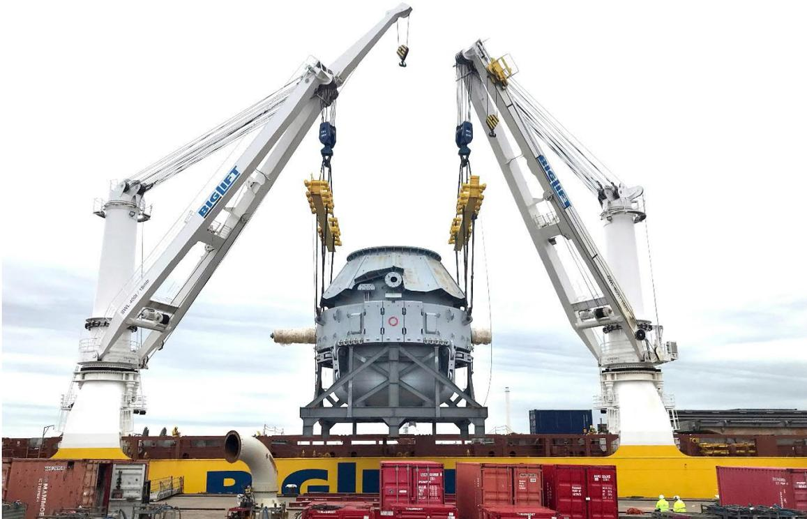
Der 330 Tonnen-LD-Konverter (BOF) von Primetals Technologies wird im Rotterdamer Hafen auf das Frachtschiff Happy River gehoben.
