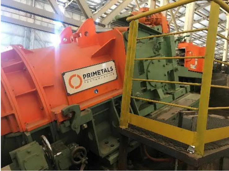
普锐特冶金技术提供的摩根智能夹送辊和摩根高速吐丝机
