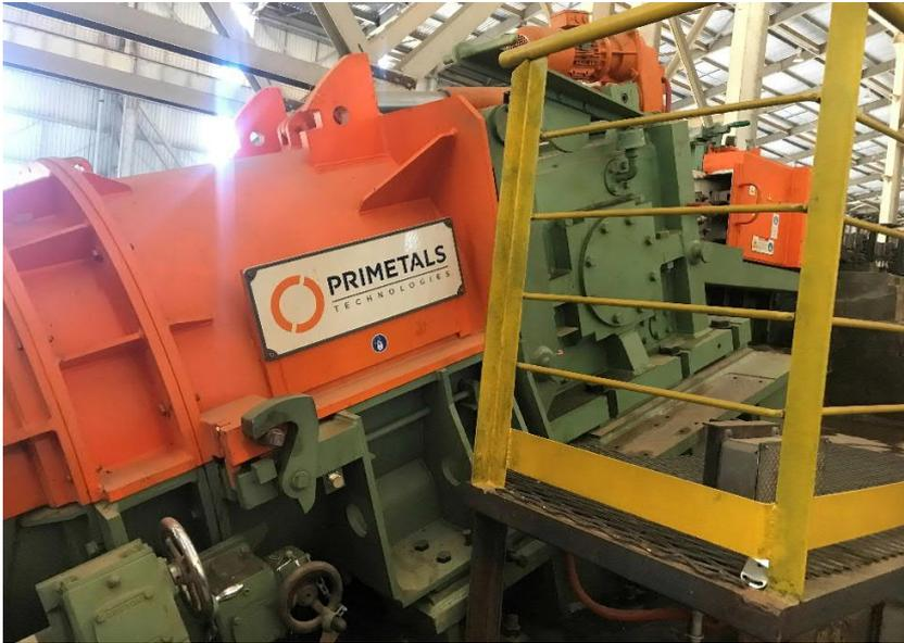
Morgan Intelligent Pinch Roll und Morgan High Speed Laying Head von Primetals Technologies
