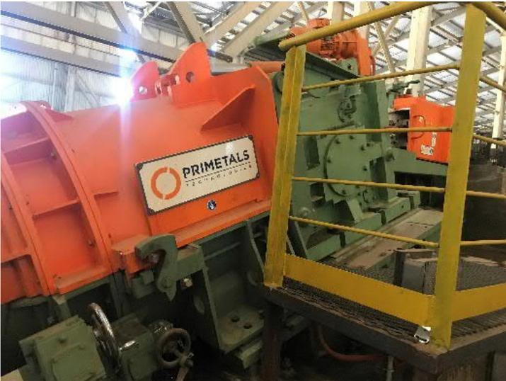
Rolo impulsionador inteligente Morgan e formador de bobina de alta velocidade Morgan da Primetals Technologies
