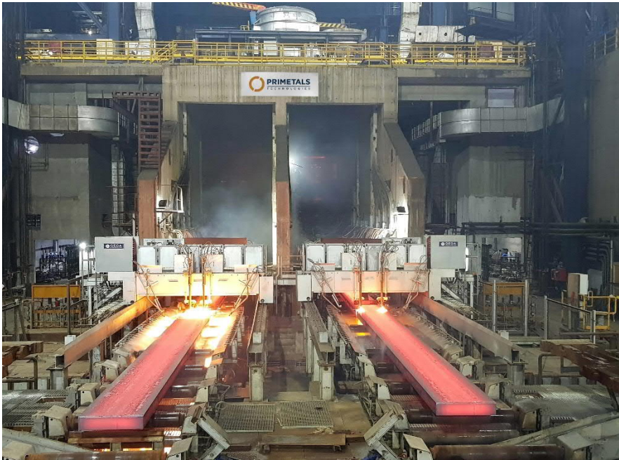
2-Strang Brammengießanlage von Primetals Technologies im Stahlwerk Dolvi von JSW Steel.
