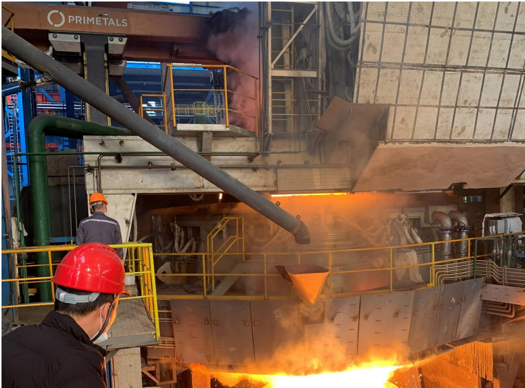
鴻泰鋼鉄で稼働するプライメタルズ テクノロジーズ製 EAF Quantum
