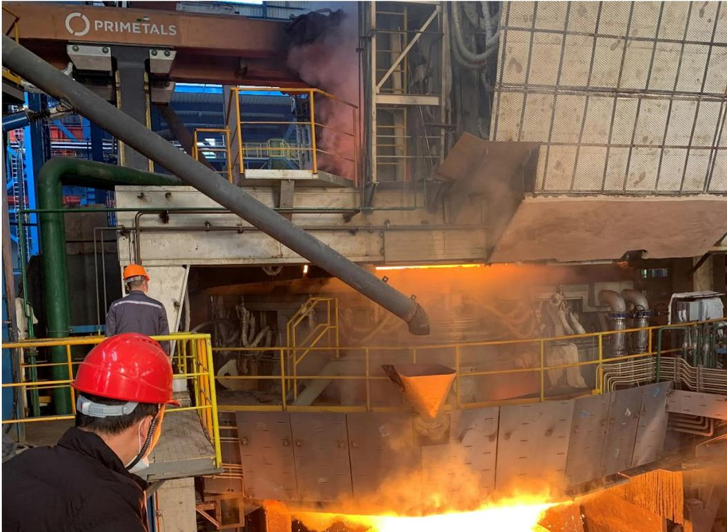
Forno elétrico a arco EAF Quantum da Primetals Technologies na Hongtai Steel.
