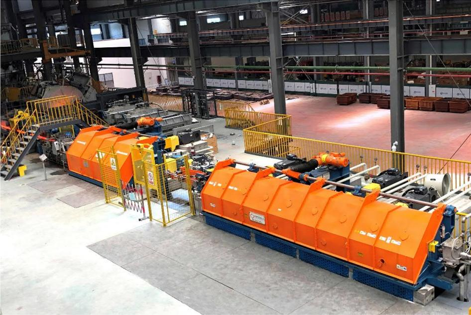
Kupferdrahtwalzwerk von Primetals Technologies.
