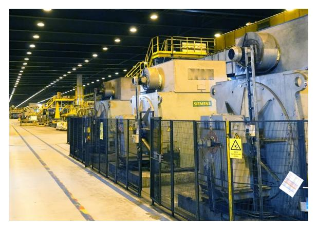
プライプライメタルズ テクノロジーズは、オウトクンプのフィンランド、トルニオにある製鉄所のステンレス鋼生産ライン(圧延・焼鈍・酸洗)の2号スタンドのドライブシステムを更新しています。
