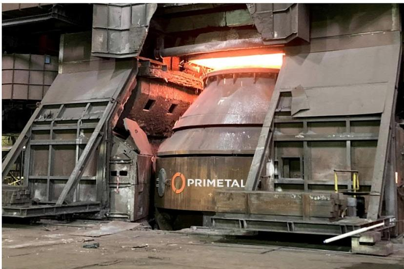
Новый 125-тонный кислородный LD-конвертер на заводе ArcelorMittal Zenica обеспечит повышенную производительность и решит проблему выплескивания металла
