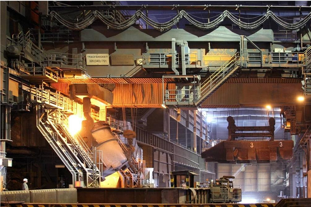
Salzgitter Flachstahl 转炉的装料操作。普锐特冶金技术最近在德国 Salzgitter 的两座 LD 转炉 (BOF)上安装了 Slag Expert 模块。
