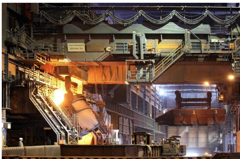
ザルツギッターフラッシュタールの転炉への材料投入の様子。プライメタルズ テクノロジーズは、ドイツのザルツギッターにある 2 基の LD 転炉（BOF）にスラグエキスパートモジュールを実装しました。
