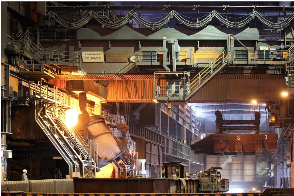
Загрузка конвертера на заводе Salzgitter Flachstahl. Компания Primetals Technologies недавно внедрила модуль Slag Expert на двух кислородных LD-конвертерах (КК) в г. Зальцгиттер, Германия.
