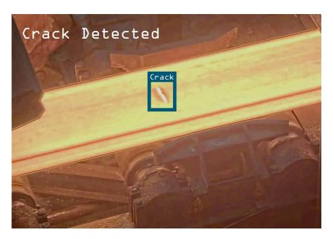
O assistente digital usa IA para detectar trincas transversais em tiras, alertando instantaneamente os operadores sobre tais defeitos.
