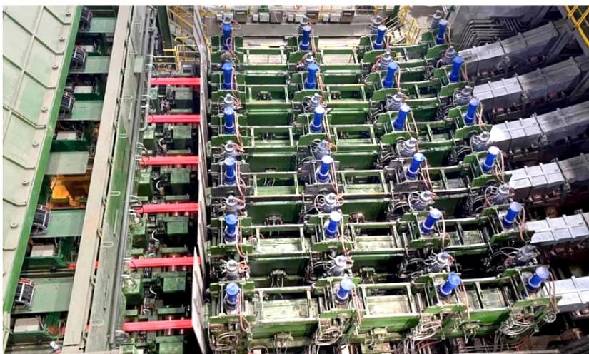
Недавно на заводе Maanshan Iron and Steel, на две недели раньше графика, была запущена в эксплуатацию комбинированная МНЛЗ для производства сортовой и балочной заготовки, поставленная Primetals Technologies
