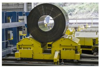
Das neue integrierte Qualitätssteuerungs-, Produktionsmanagementund Transportsystem von Primetals Technologies ermöglicht die automatisierte Qualitätsbewertung, eigenständige Bundfreigabe und die zeitnahe autonome Transportumleitung von Bunden zur Nachbearbeitung.
