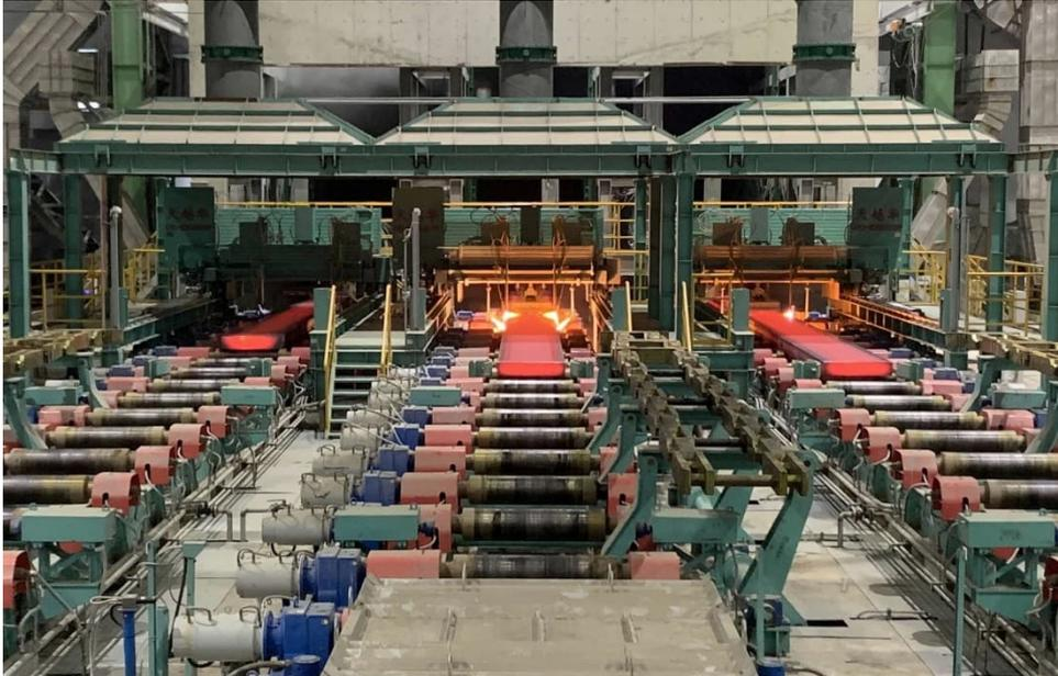
プライメタルズ テクノロジーズによる世界初の3ストランドスラブ連続鋳造機が唐山東華鋼鉄で稼動開始
