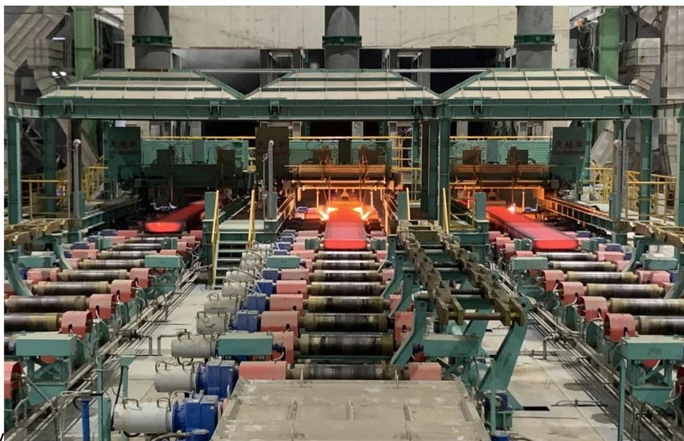
Первая в мире 3-ручьева машина непрерывного литья слябовых заготовок, поставленная Primetals Technologies, в эксплуатации на предприятии китайского сталепроизводителя Tangshan Donghua.
