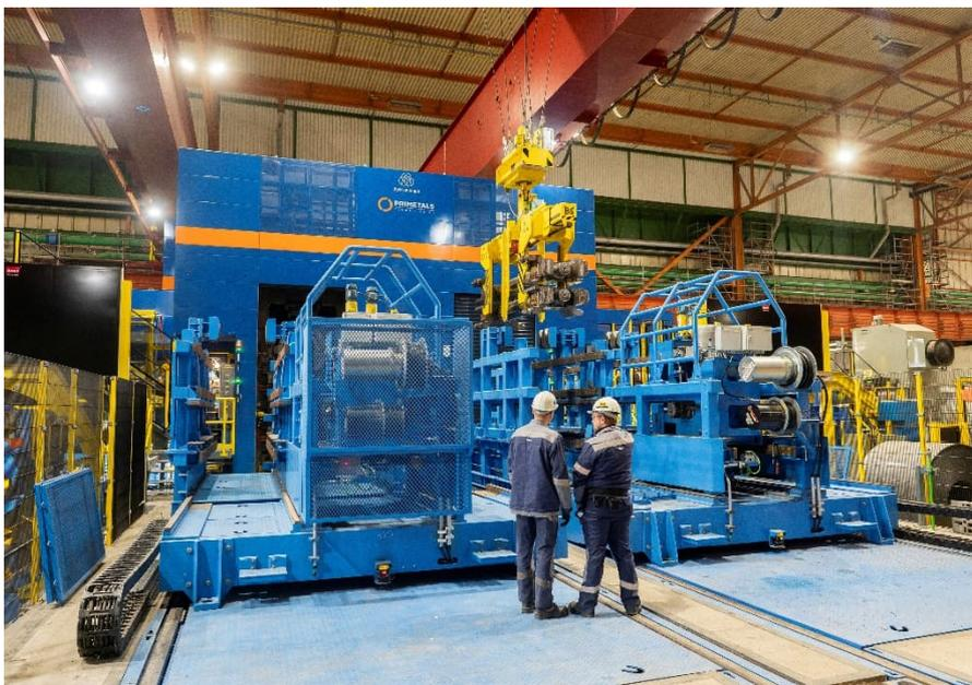
Das Werk in Bochum, Deutschland, ist das weltweit erstes Doppel-Reversier-Kaltwalzwerk mit der führenden Siliziumstahltechnologie Hyper UCM. Copyright: thyssenkrupp Steel.
