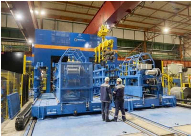
先進の電磁鋼板圧延技術ハイパーUC ミルを世界で初めて採用した2スタンドリバースコールドミル (写真提供: ティッセンクルップスチール)
