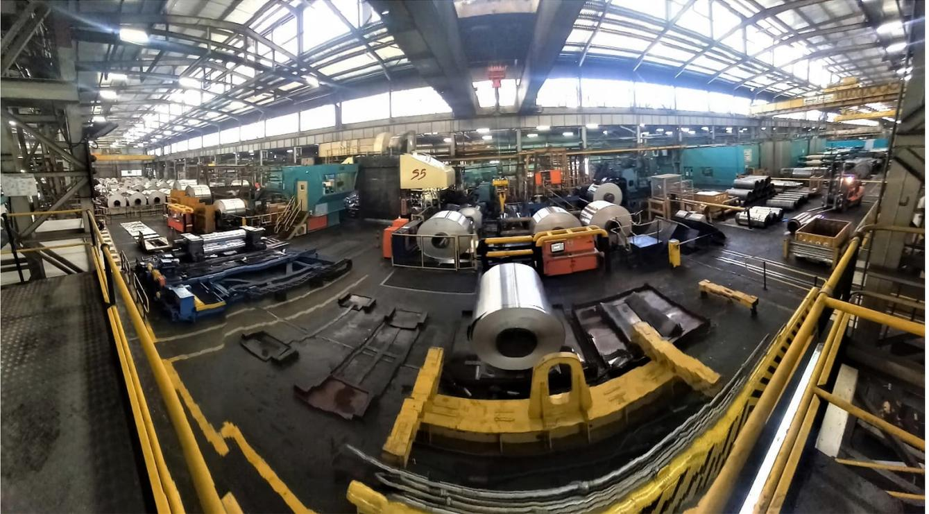
Ein Blick auf die Kaltwalzanlage „S5“. Primetals Technologies rüstet die Anlage mit Hot-Edge-Induktoren auf.
