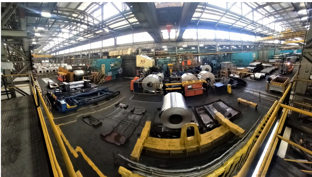
Вид на стан холодной прокатки S5. Primetals Technologies обновит стан, установив горячие кромочные индукторы.
