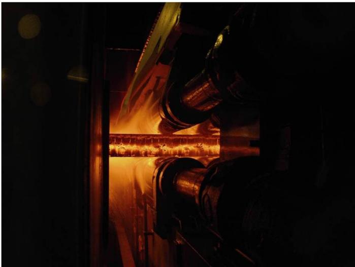
普锐特冶金技术开发了一种通过在设备安装之前调整连铸辊间距和直径而优化连铸工艺的方案。
