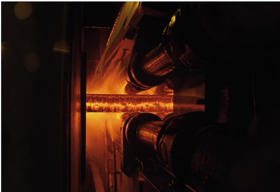
Primetals Technologies hat eine Lösung zur Optimierung des Stranggussprozesses entwickelt, bei der Abstand und Durchmesser der Rollen bereits vor der Inbetriebnahme der Anlage angepasst werden können.
