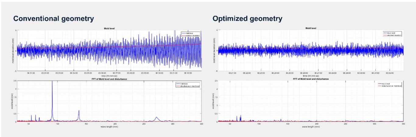
Данный график визуально отображает очень большое расхождение в стабильности между неоптимизированными и оптимизированными МНЛЗ. Он показывает отклонение уровня в кристаллизаторе машины непрерывного литья заготовки до оптимизации (слева) и после оптимизации (справа), выполненной Primetals Technologies. Расхождения показаны на верхнем графике по обеим сторонам стандартной кривой отклонения (красная линия).
