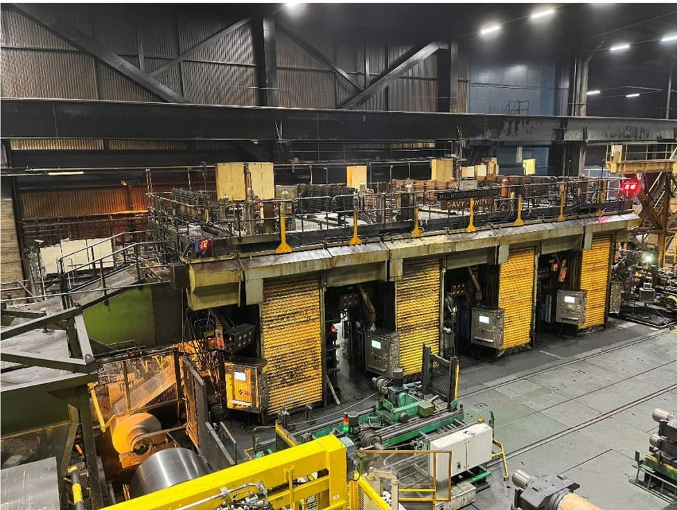
SSAB Hämeenlinna hat Primetals Technologies einen Folgeauftrag zur Antriebs-Modernisierung der Walzgerüste im Kaltwalzwerk Hämeenlinna, Finnland, erteilt. Foto der Tandem-Kaltwalzanlage des Stahlherstellers. Copyright: SSAB Hämeenlinna
