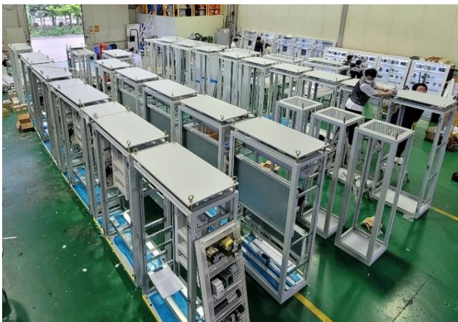
納期に間に合わせるため、調達やエンジニアリングなどの作業と並行してドライブ装置の列盤を製造
