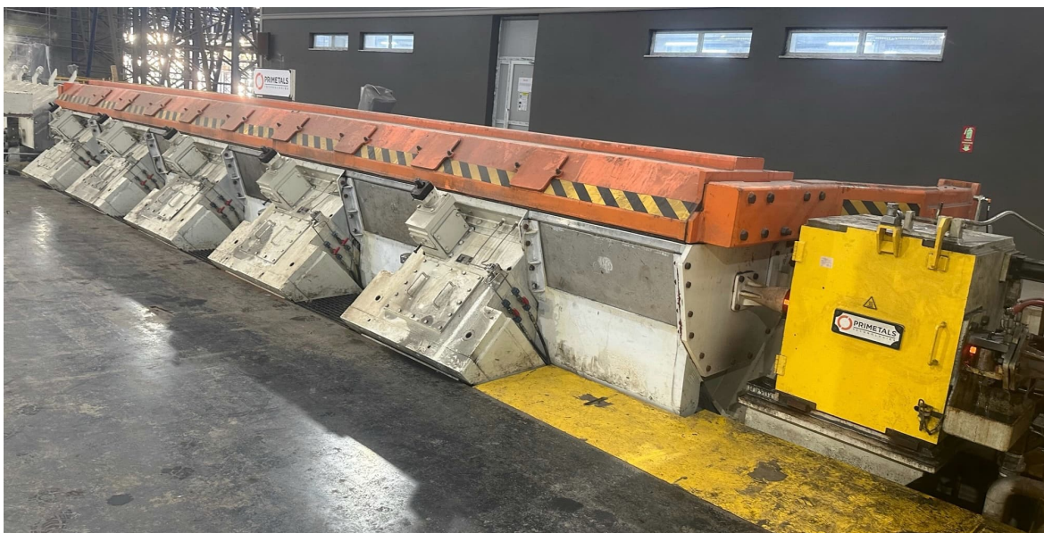
Laminador Morgan No-Twist de 10 gaiolas da Primetals Technologies.
