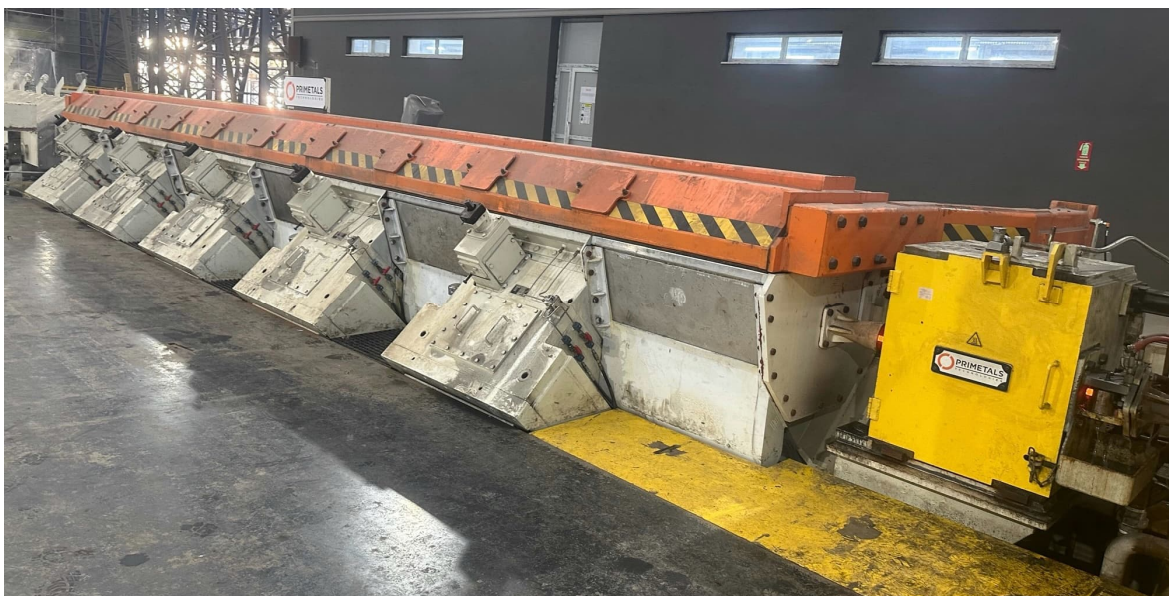
10-клетьевой стан Morgan No-Twist от Primetals Technologies.
