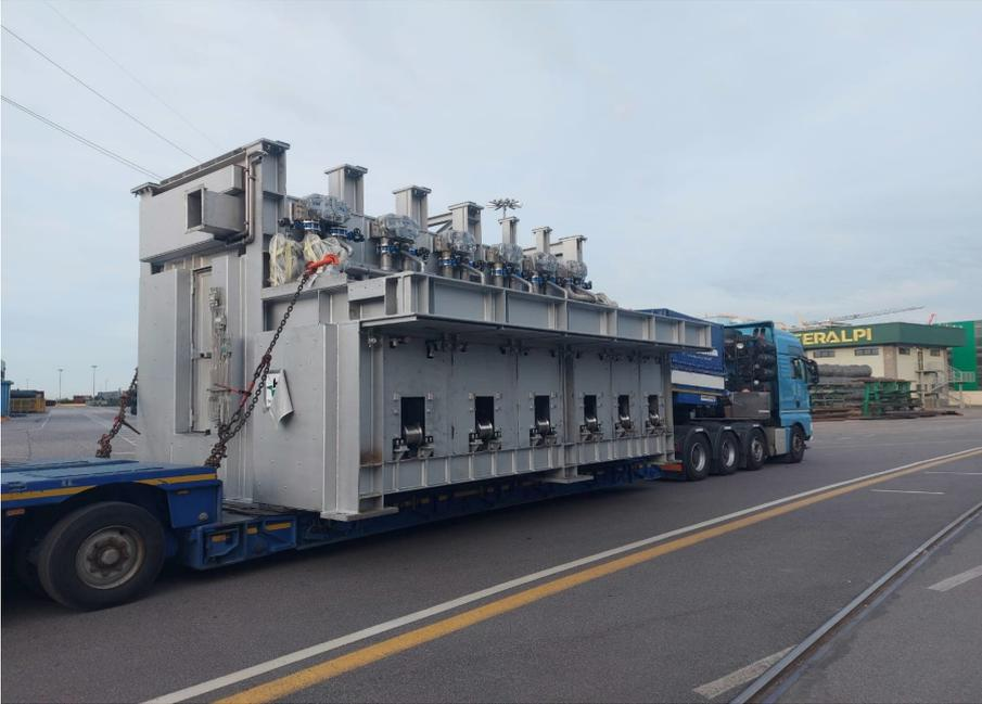
A Primetals Technologies projetou a seção curva da máquina de lingotamento contínuo de tarugo de 6 veios em uma única peça, de modo a assegurar um menor tempo de parada.
