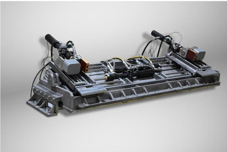
Induktionssystem für Arbeitswalzen von Primetals Technologies.
