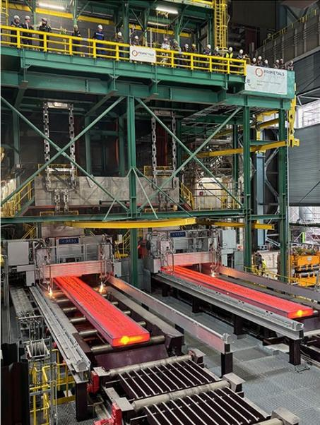
A nova máquina de lingotamento contínuo No. 4 da thyssenkrupp Steel, fornecida pela Primetals Technologies, incorpora avançadas soluções mecânicas e de automação.
