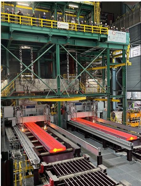
Новая машина №4 непрерывного литья заготовок thyssenkrupp Steel от Primetals Technologies оснащена продвинутыми механическими решениями и решениями для автоматизации.
