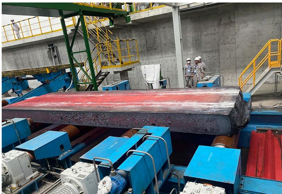
Die neue Stranggießanlage von Primetals Technologies bei Wuyang Iron and Steel ist für die Herstellung von Ultra-Dickbrammen mit bis zu 460 Millimeter Breite konzipiert.
